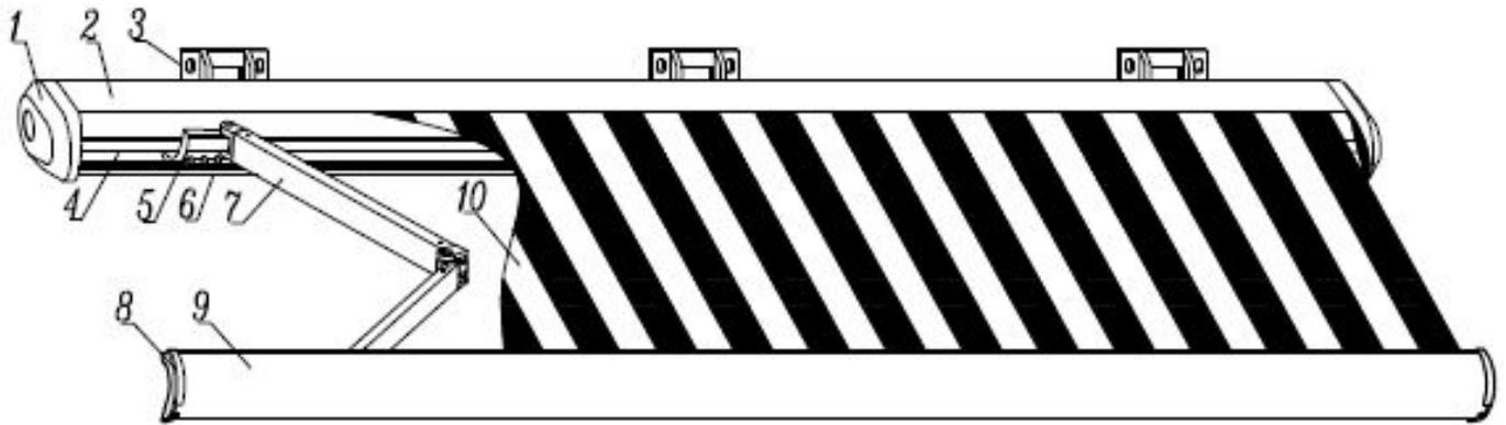
1、 support hood    2、 up plate    3、 bracket    4、 roller    5、 Arm shoulder    6、 down plate    7、 arm    8、 front bar cover    9、 front bar    10、 fabric
