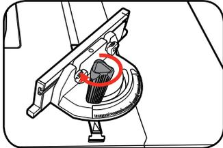
**IMPORTANT!** DO NOT PUSH THE MITRE GAUGE STOP RAIL TOO FAR TOWARD THE BLADE. THE DISTANCE BETWEEN THE STOP RAIL AND THE BLADE SHOULD BE APPROX. 20MM.
