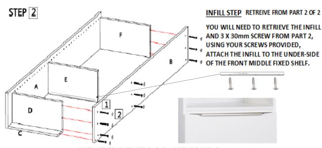
ALIGN FIXED SHELVES D, E, F + KICK BOARD C TO SIDE GABLES A+B.TIGHTEN ALL SCREWS AND CAP.
